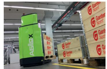
AGILOX ONE mit Doppelscherenhub, Floorspot sowie Collision Avoidance Sensoren.
